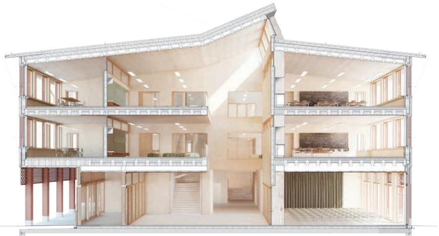
Querschnitt durch den Eingangsbereich, rechts die Aula. Bis zum Giebel misst das Gebäude eine Höhe von 16 Metern. Die schweren Deckenelemente bringen Masse und Schalldämmung.
