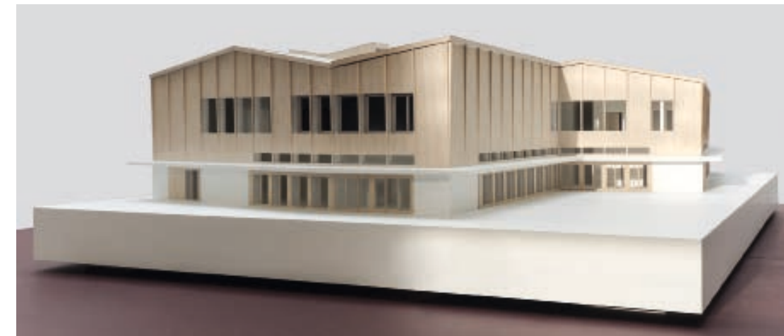
Die Gebäudestruktur und Fassaden- gestaltung wird in einem Arbeitsmodell 1 : 50 überprüft.
